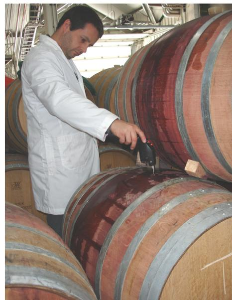
Un uso alternativo para el equipo es la sanitización de barricas vacías, normalmente realizado con la quema de azufre en el interior de ellas. Con YTWine<sup>®</sup> se puede realizar la operación inyectando directamente anhídrido sulfuroso en el interior de la bodega mediante su sistema de inyección. La dosis puede ser seleccionada mediante el panel, tal y como si se tratara de una sulfitación normal.
