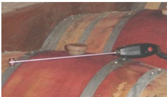
El proceso es simple, limitándose a introducir un difusor (lanza) al interior de la barrica y presionando el disparador. El equipo inyectará la dosis preprogramada en pequeños pulsos continuos, para permitir la disolución adecuada del SO<sub>2</sub> en diminutas burbujas en estado gaseoso, elevando el SO<sub>2</sub> total y libre, en base a los objetivos del Enólogo.
